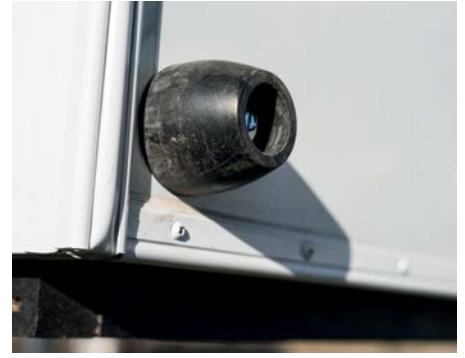
Abstandhalter aus Gummi schützen Kabine und Fahrerhaus vor Kratzern, auch puffern sie Rempler beim Aufsatteln zuverlässig ab
