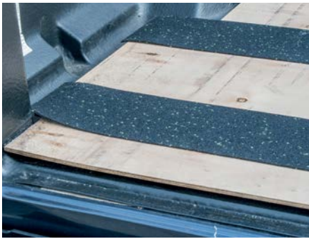
Auf losem Untergrund müssen Holzplatten unter die Stützen. Tipp für lange Lagerung: eine Plane ausbreiten gegen aufsteigende Feuchte
