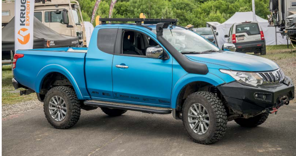
Hilfreich: Der Einbau eines modifizierten Fahrwerks erhöht die Bodenfreiheit spürbar, ebenso Fahrkomfort und Zuladungsreserve. Unten vor, oben nach dem Umbau, fünf Zentimeter plus
