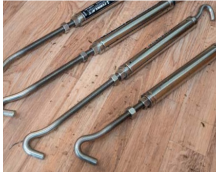
Spannschlösser aus Edelstahl oder Bronze sind eine haltbare Lösung zum Fixieren der Kabine, bei Bedarf mit Ketten verlängern
