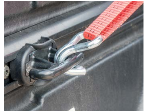
Ausschließlich zulässige Zurrpunkte verwenden und eingesetzte Haken gegen Herausfallen sichern. Die Verspannung regelmäßig prüfen
