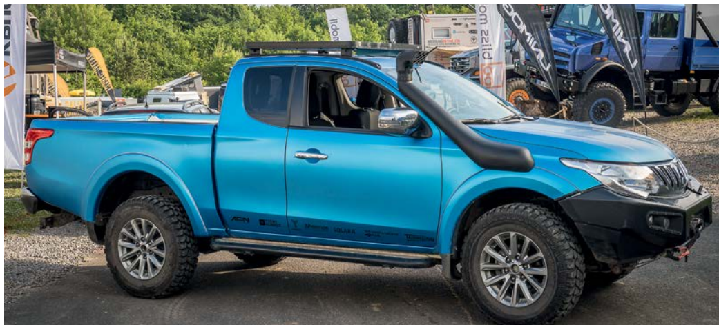
Hilfreich: Der Einbau eines modifizierten Fahrwerks erhöht die Bodenfreiheit spürbar, ebenso Fahrkomfort und Zuladungsreserve. Unten vor, oben nach dem Umbau, fünf Zentimeter plus
