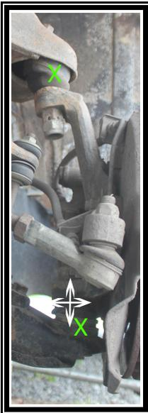
Ein Klappern / Quietschen / Poltern unter dem Sitz tritt bei unebener Straße auf, wenn ein Traggelenk ausgeschlagen ist :: Auto anheben und am Rad wackeln. Notfalls mit dem Hebel des Wagenhebers. Bewegt sich der Achsschenkel im Bezug auf den unteren, oder oberen Querlenker, dann muss das Gelenk / die Gelenke getauscht werden.
